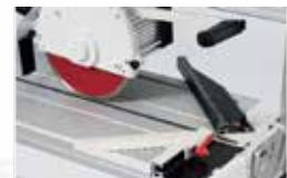
Com guia de corte ajustável que permite escolher o ângulo de corte pretendido em cada caso: Basta rodar a cabeça da máquina de 90º até 45º.
